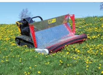
Funkferngesteuerte Mähraupe mit Grasschneidewerk (oben) und mit einem Anbaugerät zur Aufnahme des Mähguts (unten). Foto: KLP Baumaschinen GmbH
