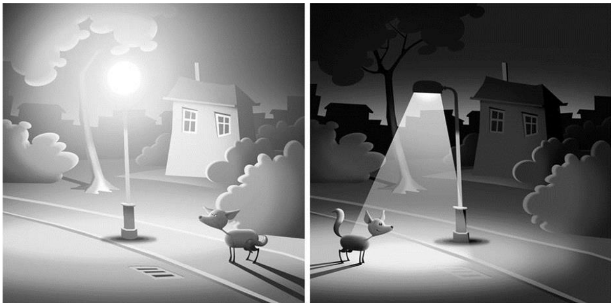
Abbildung 18: Illustration von einer Kugelleuchte, ohne Begrenzung des nach oben gerichteten Lichtes (ULR) (links) und abgeschirmter Straßenleuchte, die nur den Infrastrukturbereich mit Gehweg beleuchtet, ohne Abstrahlung auf Wohnräume oder Habitate (rechts). Illustrationen von Rainer Stock im Auftrag des „Loss of the Night“ Netzwerks LoNNe (EU-COST-Aktion ES1204) © 2016.
